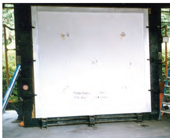
LITEBUILT® ПАНЕЛЬ ПОДГОТОВЛЕННАЯ ДЛЯ ИСПЫТАНИЯ НА ОГНЕСТОЙКОСТЬ
