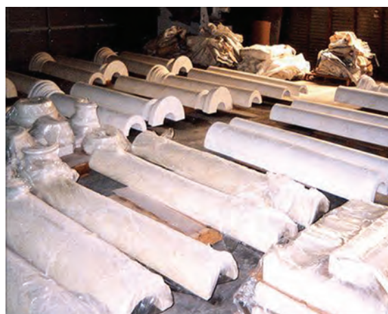
КОЛОННЫ ИЗ LITEBUILT® ЛЕГКОГО ПЕНОБЕТОНА
