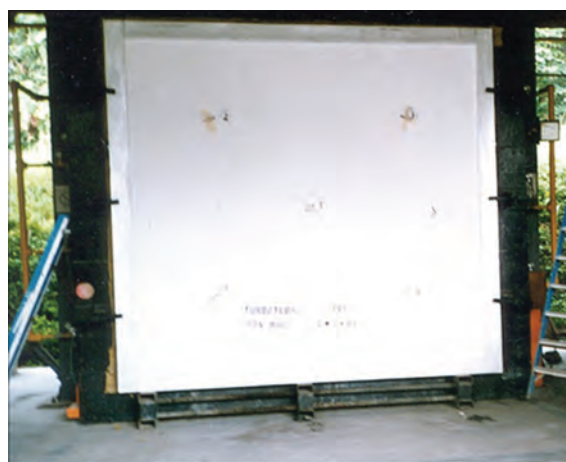
LITEBUILT® ПАНЕЛЬ ПОДГОТОВЛЕННАЯ ДЛЯ ИСПЫТАНИЯ НА ОГНЕСТОЙКОСТЬ
