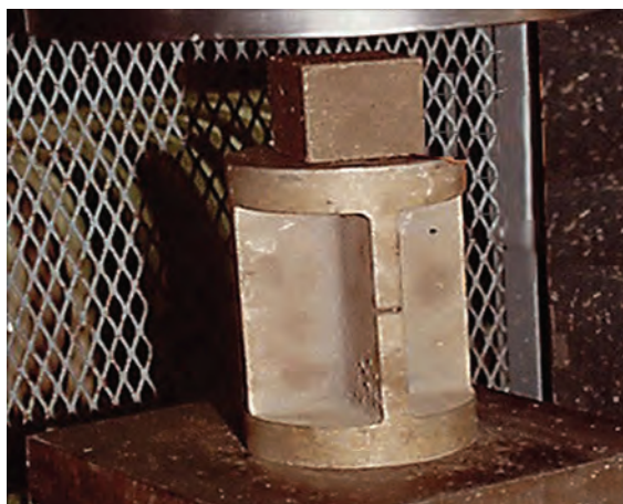
МАШИНА ДЛЯ ИСПЫТАНИЯ ПРЕДЕЛА ПРОЧНОСТИ ПРИ СЖАТИИ
